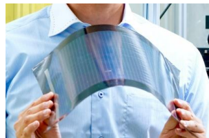
ペロブスカイト太陽電池 軽くて下敷きのように曲がる（出所：東芝）
