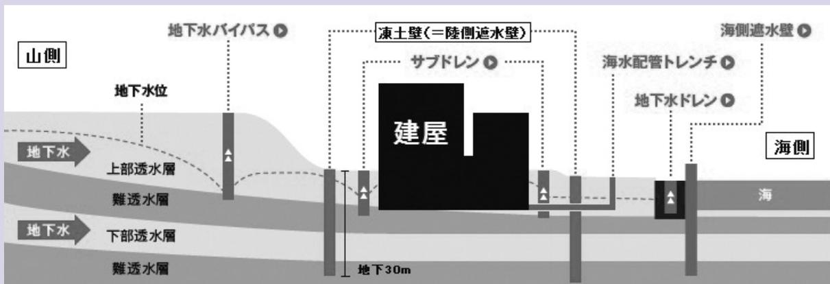
この図は発電所を横から見た図です。通常、地下水は山側から海側に向かって流れ、その途中にある建屋に流れ込みます。それを図のように、地下30mの深さに達する凍土壁（陸側遮水壁）で遮り、建屋に入らないよう、流れを変えてしまうのです。
