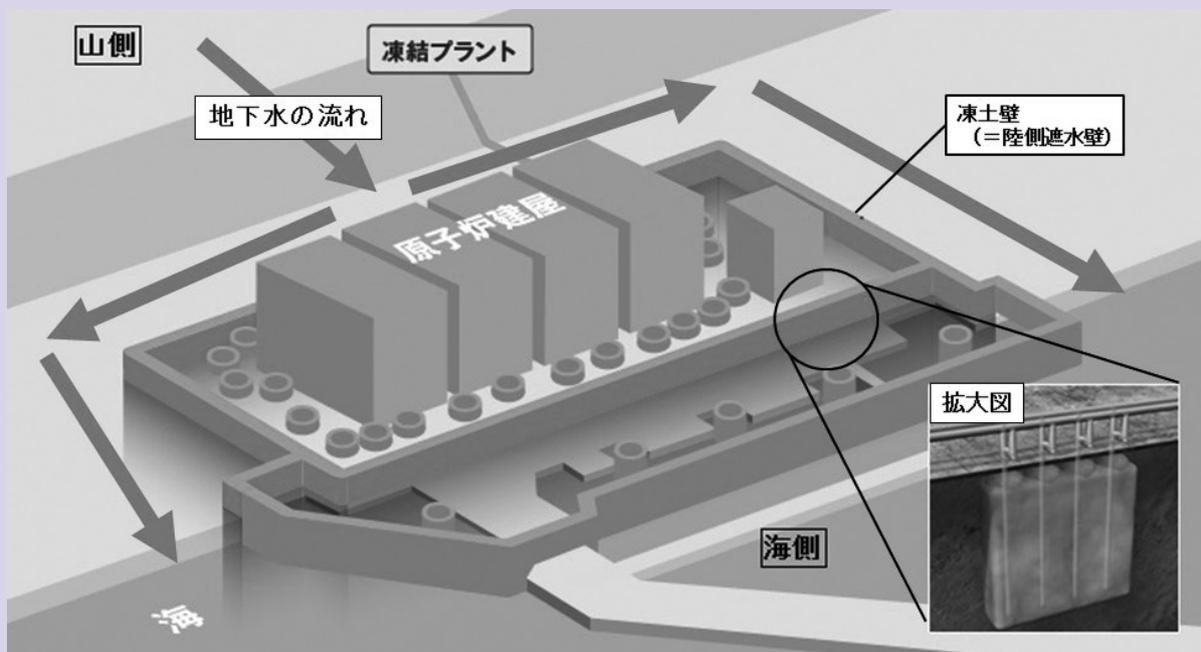
山側から流れてきた地下水は、凍土壁に当たると図のように分かれて凍土壁に沿って進み、そのまま海へと流れます。
