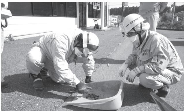
▲線量の高いアスファルトの継ぎ目
